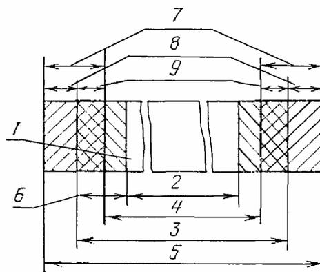
1 - деталь; 2 - размер детали; 3 - номинальный размер поковки; 4 - наименьший предельный размер поковки; 5 - наибольший предельный размер поковки; 6 - величина припуска; 7 - допуск (поле допуска); 8 - положительная величина допускаемого отклонения; 9 - отрицательная величина допускаемого отклонения
